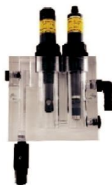
开放式多通道流通池安装
