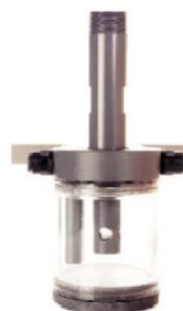
密闭式流通池安装
