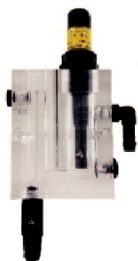
开放式流通池安装
