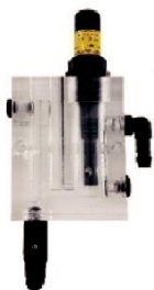
开放式流通池安装
