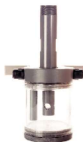
密闭式流通池安装
