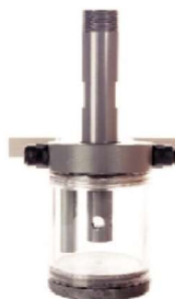
密闭式流通池安装
